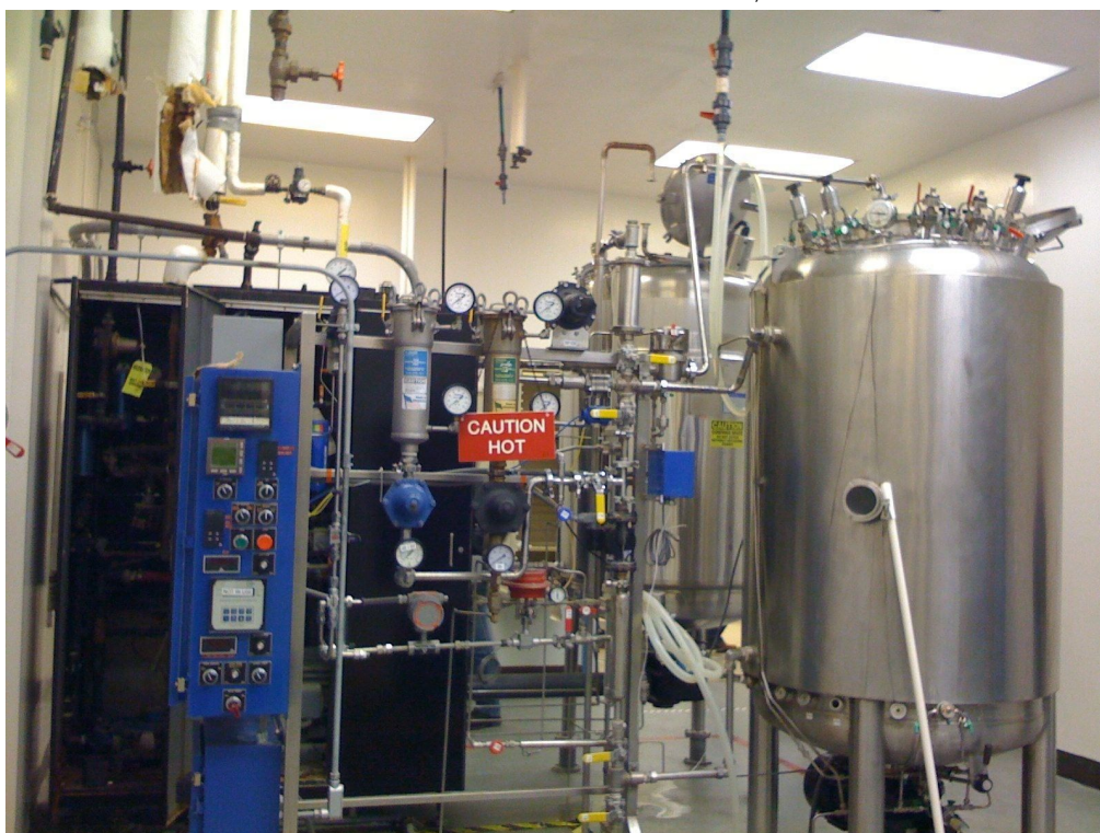
Im Stahltank bieten sich den Hefezellen optimale Bedingungen, um sich zu vermehren.Bild: Peter Grotzinger CC-BY-SA-3.0
