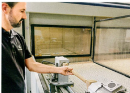
Mit Drehvorrichtung auf der CNC ist die Formgebung eines spirallig bearbeiteten Stuhlbeins eine Sache von wenigen Minuten.
