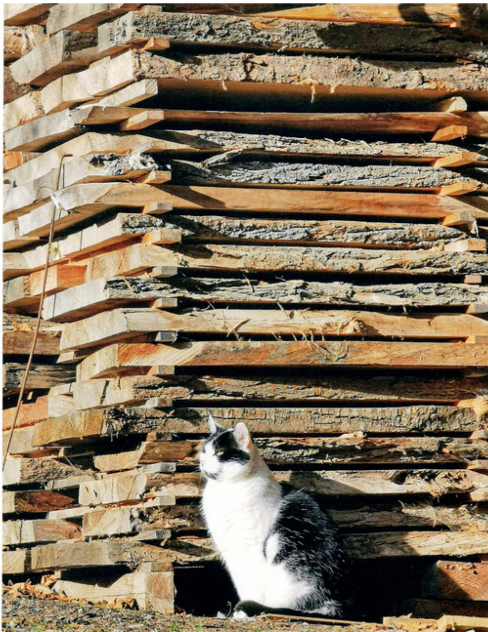
Bild: Christian Härtel Der Schnittholzstapel zum Trocknen des eigenen Holzes ist bei Schreinereien nicht mehr allzu häufig anzutreffen.
