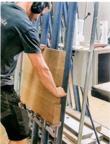
Simon Knapp braucht den Verleimständer andauernd, denn Massivholz ist bei Werkholz normal. Zulagen stehen nach Länge sortiert im Wagen bereit.
