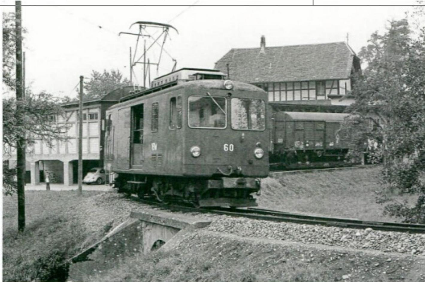
Der De 4/4 60 am 24.8.1971 im Anschlussgleis mit 35-Meter-Radius, Wegmühle in Bolligen. Foto: E. Gfeller
