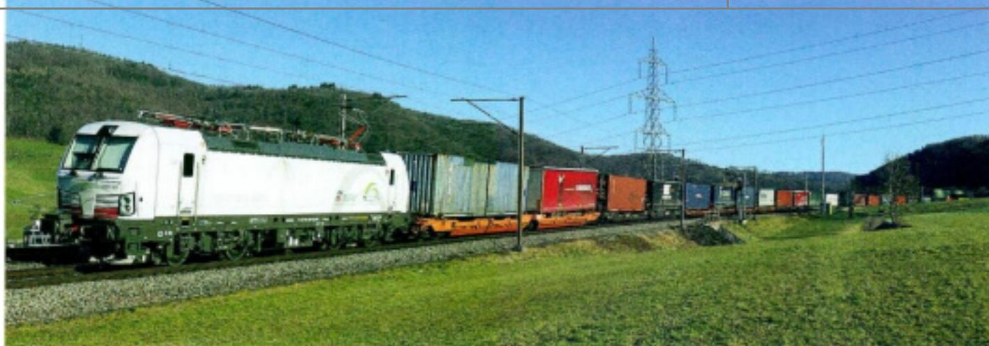
Die 7193 307 mit ersten Betriebsspuren als einer der neuen TXL-Vectron für den Nord-Süd-Verkehr mit einem Taschenwagenzug aus Italien oberhalb Frick am 11.1.2025. Foto: A. Niederberger La 7193 307 «legerement patinee», une des nouvelles Vectron TXL pour le trafic Nord-Sud, en tete d'un train de wagons-poches en provenance d'Italie. En dessus de Frick, le 11.1.2025.
