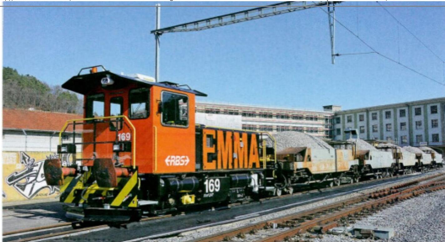
Der Tmf 169 mit den aufgebockten Talbot-Schotterwagen X 901-905 am 6.4.2018 in Bolligen B-Anlage. Foto: U. Aeschlimann
