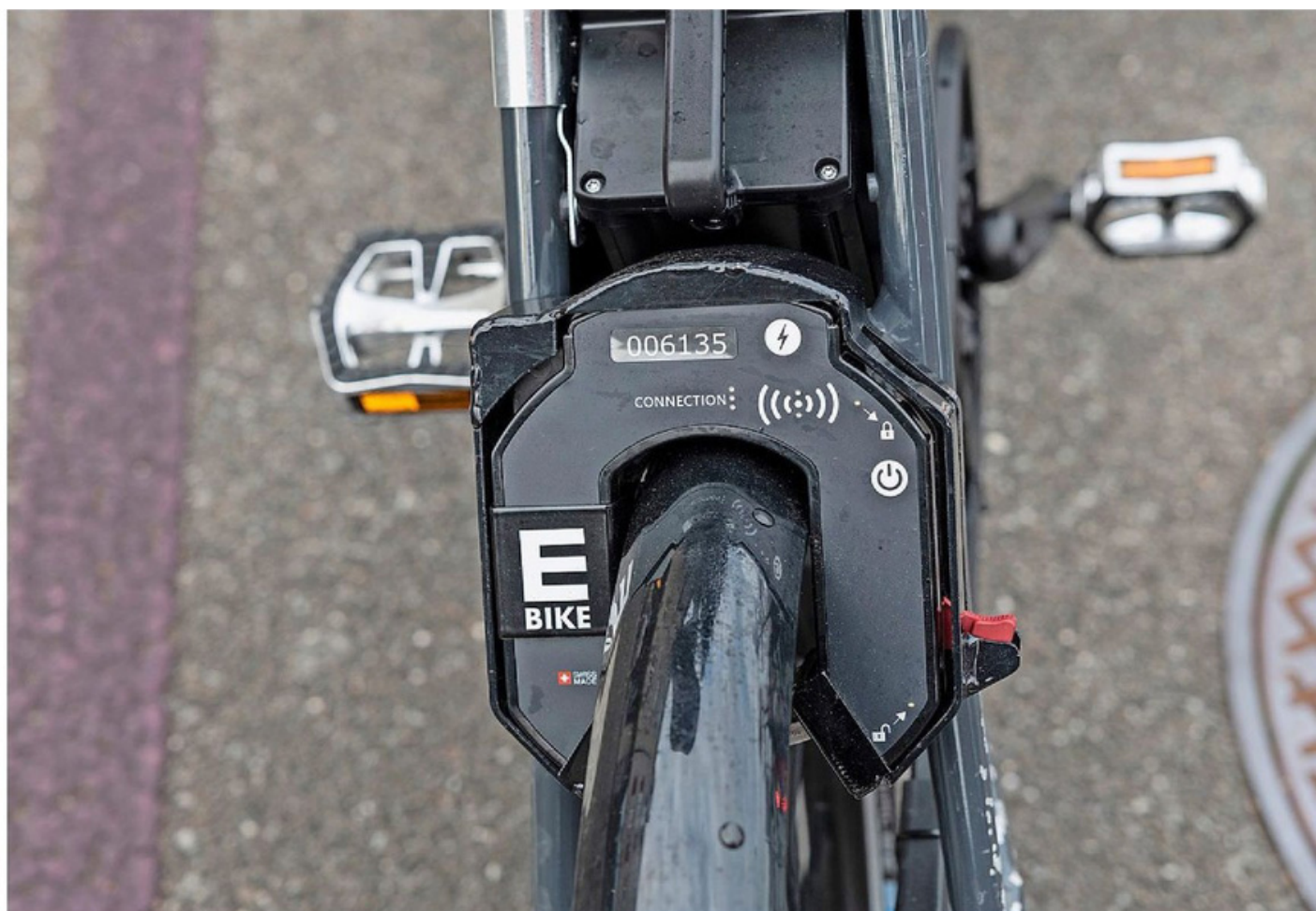
CONNECTION- («=») Die augenfälligste Neuerung bei den aufgerüsteten Publibikes ist das Schloss. Es enthält jetzt einen Knopf, den man zum Entsperren drücken muss. Foto: BeatMathys
