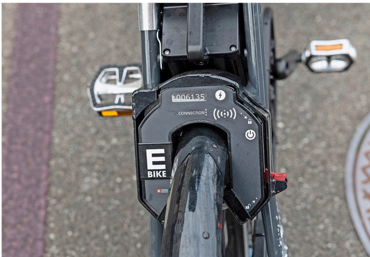
Die augenfälligste Neuerung bei den aufgerüsteten Publibikes ist das Schloss. Es enthält jetzt einen Knopf, den man zum Entsperren drücken muss. Foto: Beat Mathys
